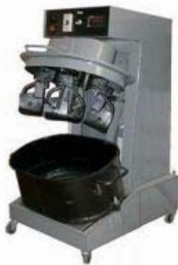
Рисунок 2 - Бетоносмеситель лабораторный СЛ-ЦБ-10 (10 л)
