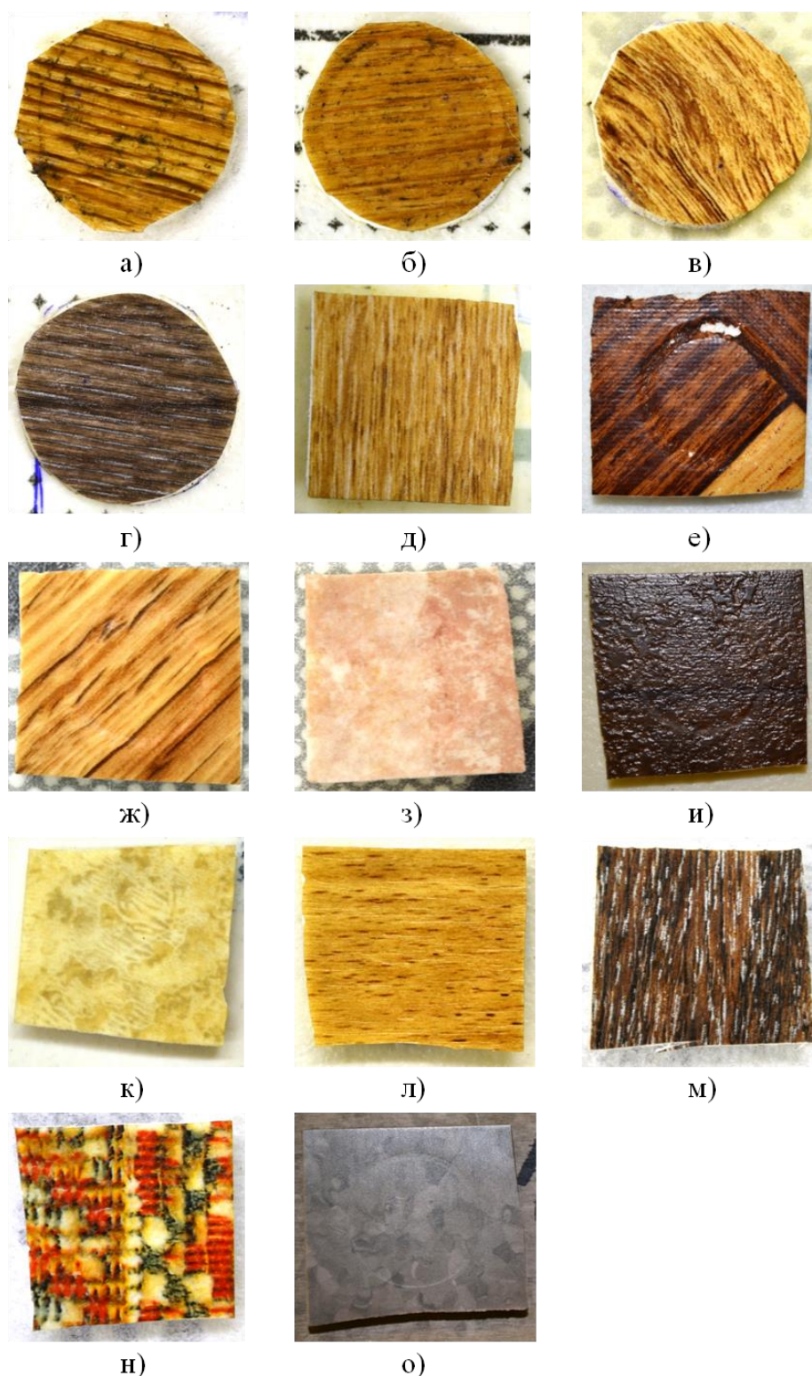
Рисунок 16 – Износ защитного слоя образцов после трибологических испытаний: а – образец №1 (Мегаполис Фалько); б – образец №2 (Респект Пекан); в – образец №3 (Дельта Сорбона 3); г – образец №4 (Респект Далтон); д – образец №5 (Респект Степ 40); е – образец №6 (Омега Минос 2); ж – образец №7 (Юрапшен Бора 1); з – образец №8 (Юрапшен Бранда 7); и – образец №9 (Премьер Тайра 3010); к – образец №10 (Премиум Кама); л – образец №11 (Респект Степ); м – образец №12 (Идиллия Танго 3); н – образец №13 (Идиллия Килим 1); о – образец №14 (Мелодия 2617).
