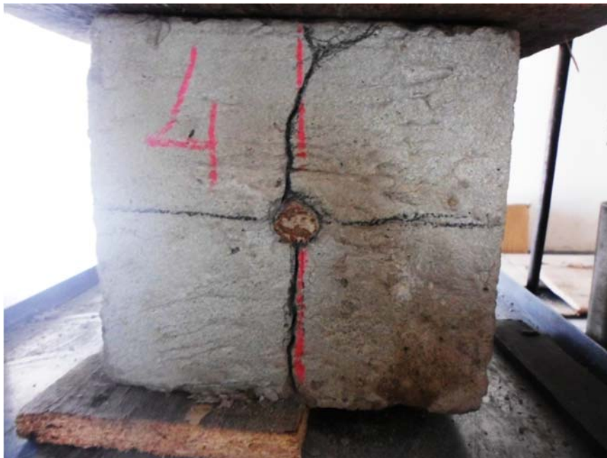
Рисунок 1 - Образец с неизвлекаемым круглым стержнем–шпунтообразователем и характерный результат испытания по сечению шпонки.
