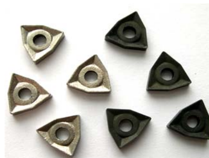
Рисунок 2 - Твердосплавные шестигранные пластины WNUM-080404 с никель-медными покрытиями (светлые) и без покрытий (темные).
