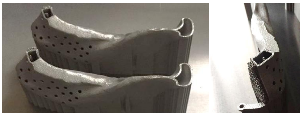
Рисунок 13 - Модель нижней челюсти (промежуточный вариант), распечатанная на принтер Melt-Master (производство ГК «Росатом»)из титанового порошок марки BT10 (производство Россия)
