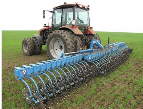
Рисунок 16 – Мотыга борона ротационная
