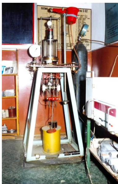
Рисунок 1. Установка для испытания грунтов в условиях трехосного сжатия конструкции Азберген М.И.
