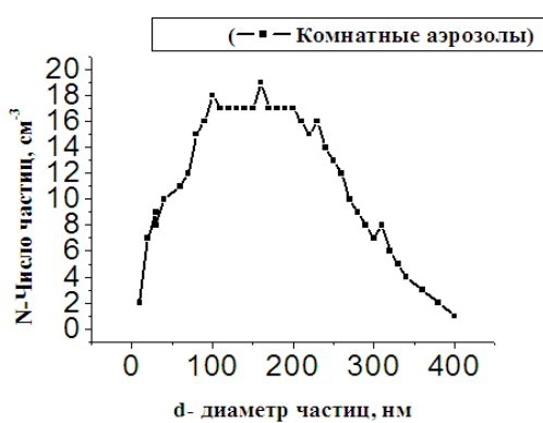
Рис.1. Зависимость концентрации частиц от диаметра аэрозоля. Полная концентрация воздуха в комнате- 3 \cdot 10^3 см 3 .
