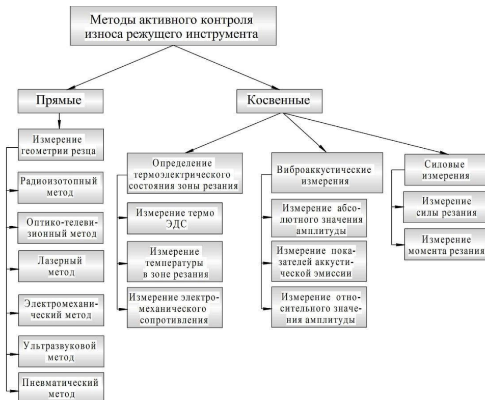
Рисунок 4 – Классификация методов активного контроля состояния режущего инструмента.
