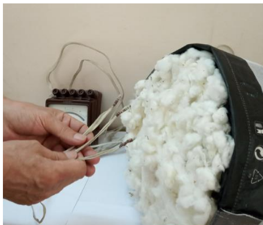
Рис.2. Терморезистор для измерения температуры образца хлопка-сырца
