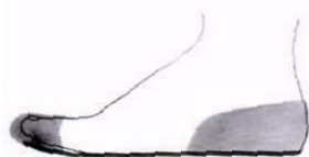
Рис 4 - Особенности расположения подноски и задника на колодке
