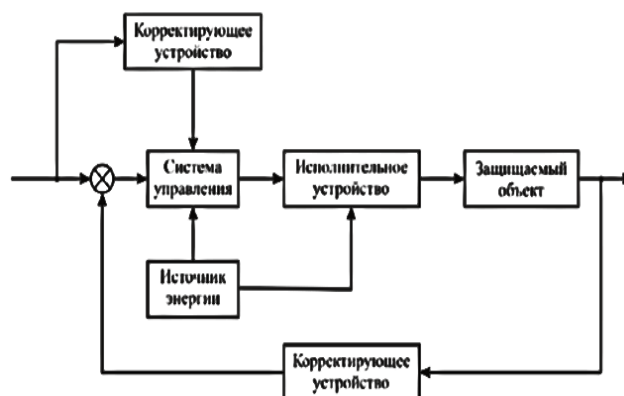
Рис.4. Структурная схем метода активной виброзащиты.
