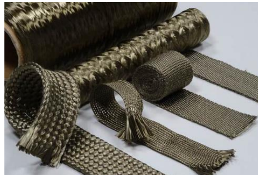
Рисунок 2. Базальтовая ткань, нетканое полотно а также собранная продукция образцы
