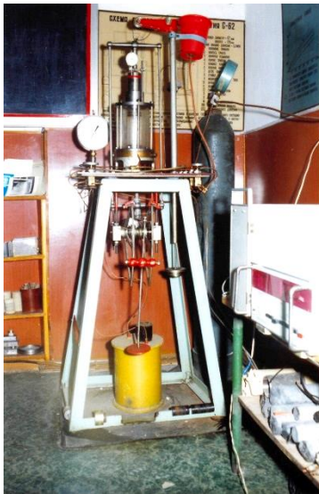
Рисунок 1. Экспериментальная установка для испытания грунтов в условиях трехосного сжатия конструкции Воронцова Э.И.-Азбергана М.И.
