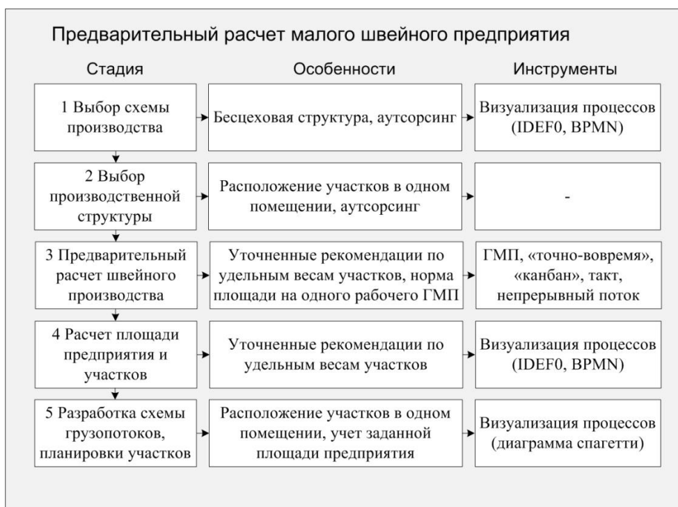
Рисунок 1 - Схема методики предварительного расчета малого швейного предприятия
