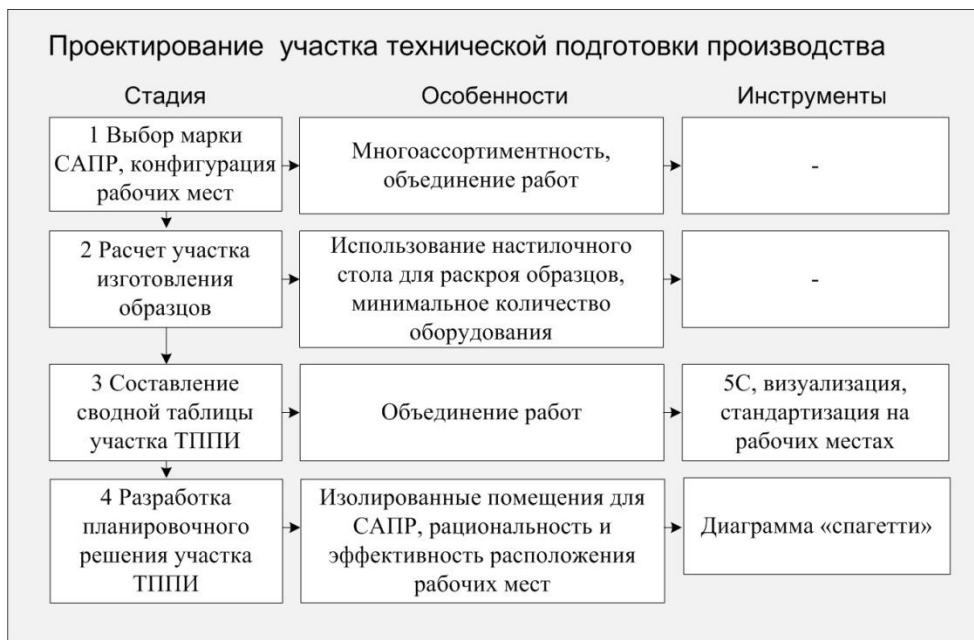
Рисунок 3 – Схема методики проектирования участка технической подготовки производства изделий малого предприятия
