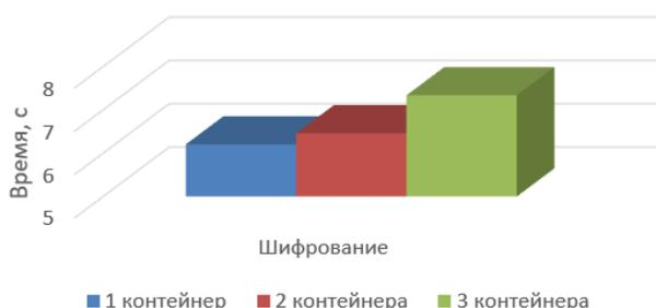
Рисунок 6. Тестирование скорости работы с оперативной памятью на основе шифрования при разном количестве запущенных контейнеров.
