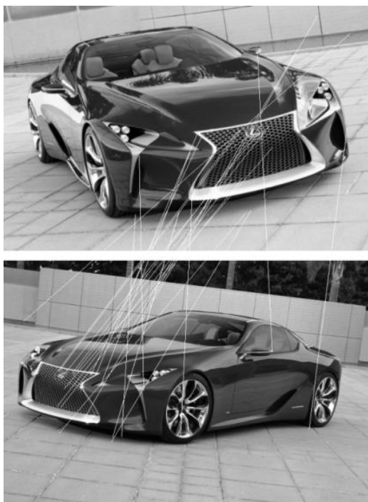
Рисунок 1 – Пример сопоставления изображений методом ASIFT
