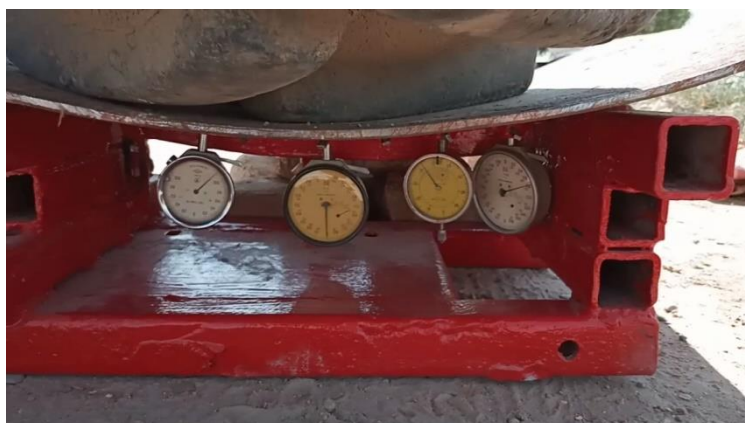
Рис.2. Ведущее колеса 18,4-34 TR-135 10PR New Holland TD5 110 для определения деформационных свойств при помощи индикатора часовой модели ИЧ-150 (давление в шинах 0,10 МПа)
