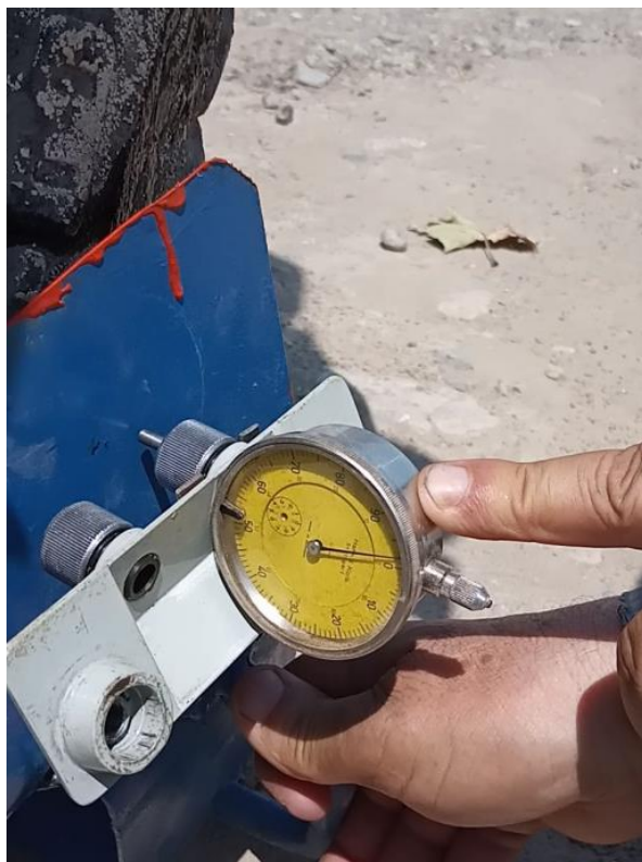
Рис.5. Установки для измерения деформации шин направляющего колеса 12-16 Л-163 при помощи индикатора часовой модели ИЧ-150 (давление в шинах 0,10 МПа)
