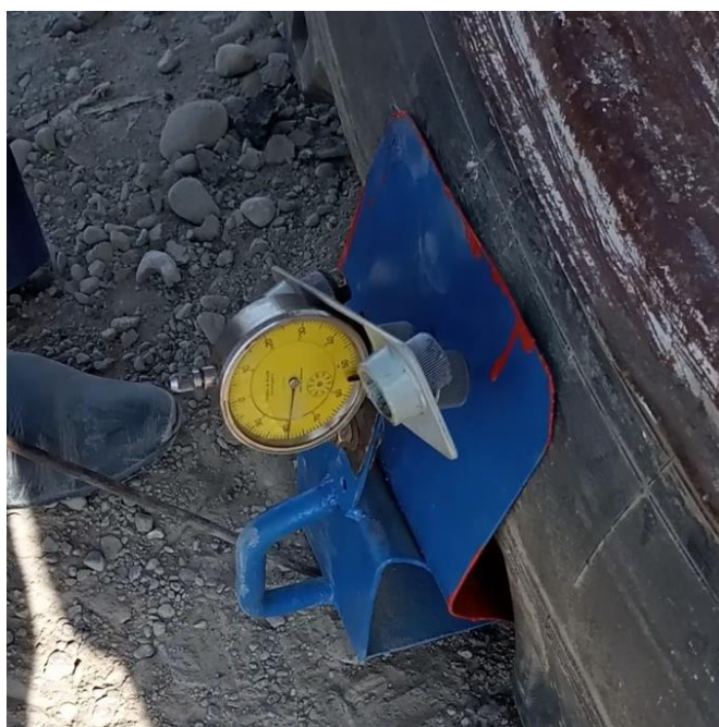
Рис.4. Ведущее колесо 13,6 R38 ЯР-318 для определения деформационных свойств при помощи индикатора часовой модели ИЧ-150 (давление в шинах 0,11 МПа)
