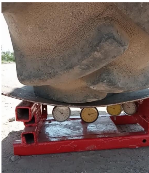
Рис.1. Индикатор часовой модели ИЧ-150 (давления в шинах 0,10 МПа) ведущего колеса 13,6 R 38 ЯР-318 для определения деформационных свойств.
