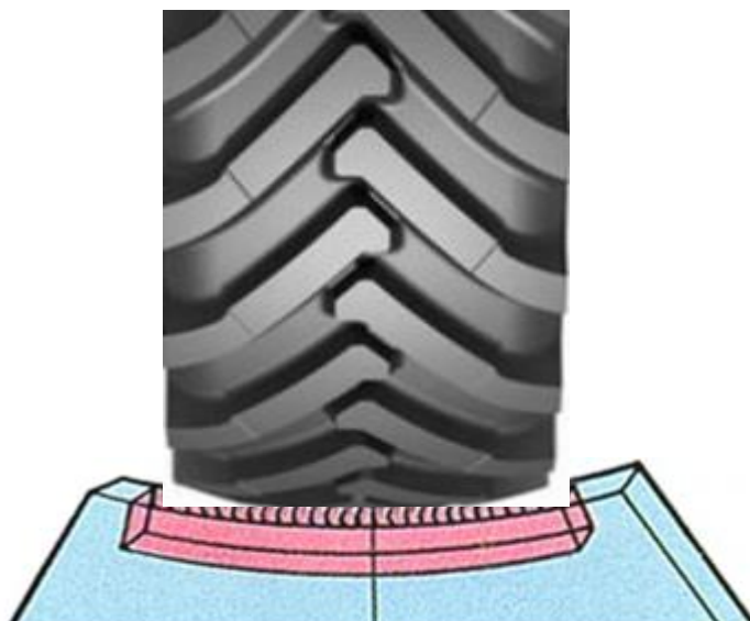
Рис.5. Площадь контакта шины с почвой в зависимости от нагрузки размеров шин: 1-баллон; 2-площадь контакта.
