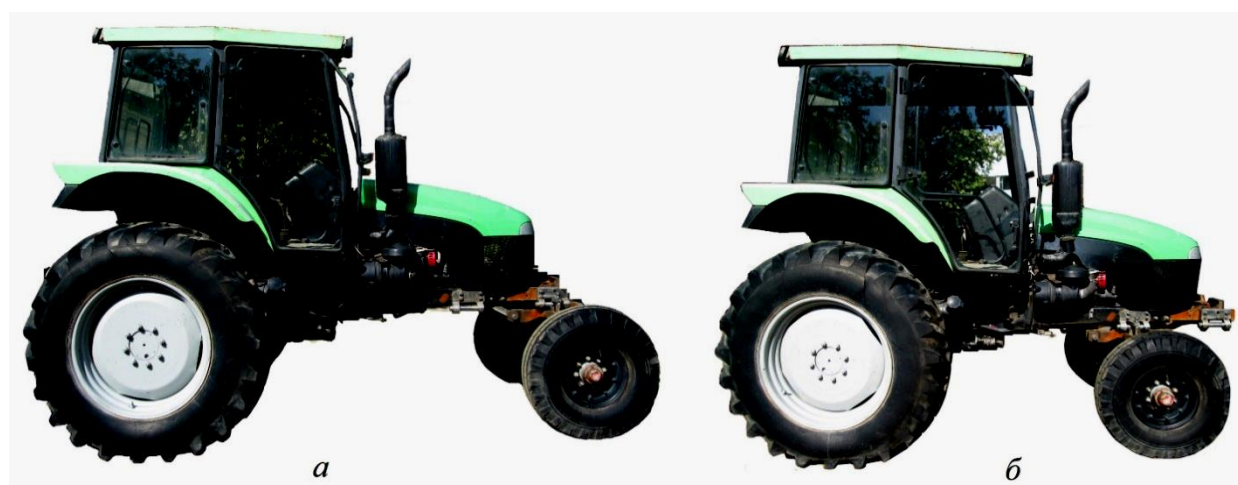
Рис.1. Трактор с изменяемой базой TTZ-1080 при: а - удлиненной базе; б – укороченной базе
