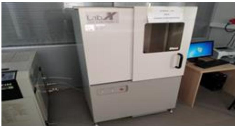
Рис.1. Порошковая рентгеновская дифрактометрия. XRD-6100.
