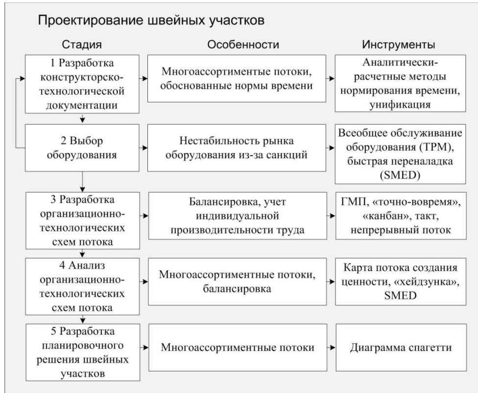
Рисунок 2 - Схема методики проектирования швейных участков
