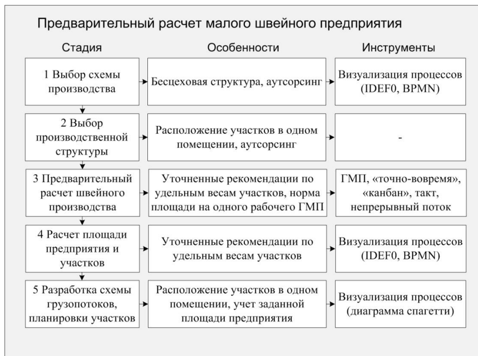
Рисунок 1 - Схема методики предварительного расчета малого швейного предприятия
