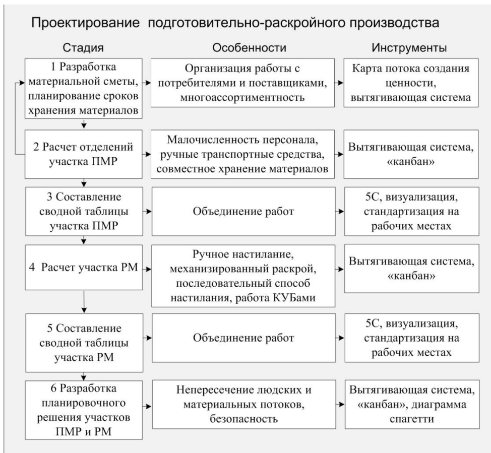
Рисунок 4 - Схема методики проектирования участков подготовительно-раскройного производства
