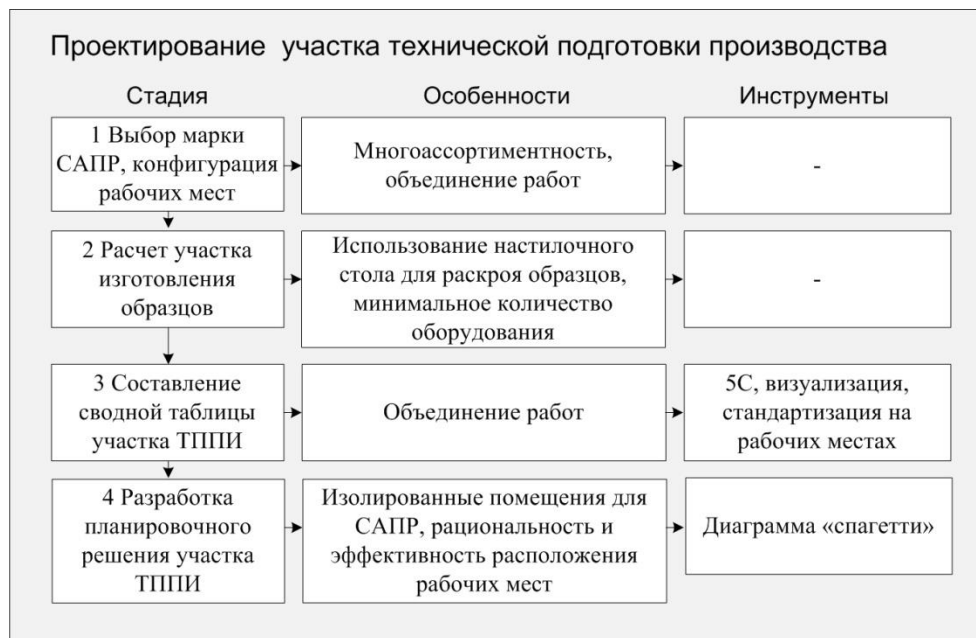
Рисунок 3 – Схема методики проектирования участка технической подготовки производства изделий малого предприятия
