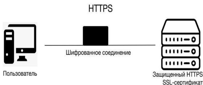
Рисунок 4. Схема веб-протокола HTTPS.
